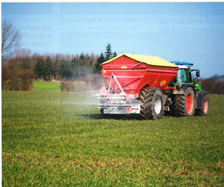
Omkring 11,5 kubikmeter gødning eller kalk er der plads til i K105. Når der spredes kalk, skal man imidlertid montere kalktallerkner på sprederen
