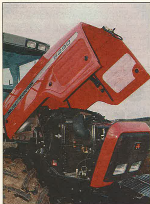
For at lette serviceringen af motoren, kan motorhjelmen nu vippes op. Ønskes der endnu mere plads, kan sidepladerne tillige let afmonteres.
