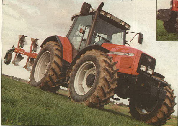
Massey Ferguson 6200 er udstyret med MF's nye transmissions, som har koblingsfrit vendegear. Traktoren har en sekskylindret Perkins turbomotor, der yder 135 hestekræfter.
