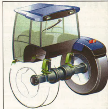
Comfort Ride kalder New Holland førerhusets affjedring. Systemet er med til at reducere de chokbelastninger, som overføres til føreren. Systemet fungerede stort set efter hensigten, men manglede lige den sidste afspunding for at fungere optimalt.
