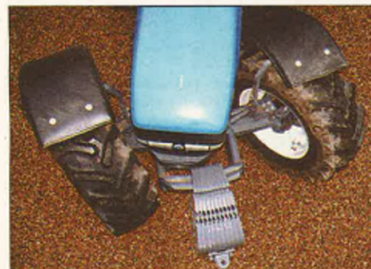
Navene på Supersteer akslen drejer op til 46 grader, og samtidig knækker aksel med op til 19 grader. Totalt giver det et styrslag på hele 65 grader og dermed en lille venderadius.
